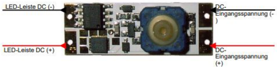
Abb.1 - Anschluss der Pins des Dimmermoduls
